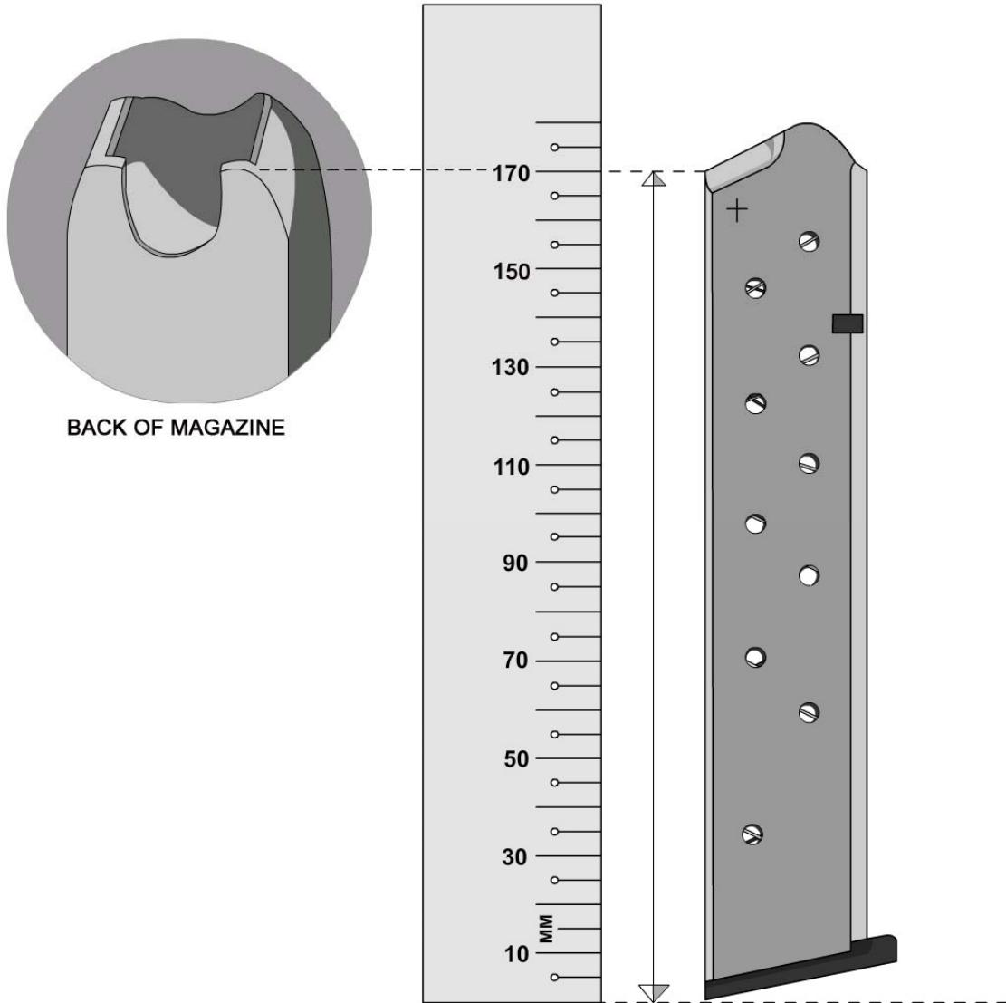
Η γεμιστήρα τοποθετείται όρθια πάνω σε επίπεδη επιφάνεια, και η μέτρηση ξεκινά από την επίπεδη επιφάνεια προς τα επάνω μέχρι την πίσω πλευρά των χειλιών τροφοδότησης, όπως απεικονίζεται. Μόνο ίσιες και άκαμπτες γεμιστήρες επιτρέπονται (δηλ. εύκαμπτες, κυλινδρικές, "J", "L", "T" ή παρόμοιοι σχήματος γεμιστήρες απαγορεύονται).
